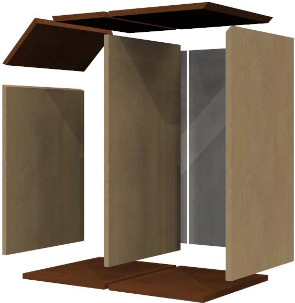
Explosionszeichnung eines Korpusses
